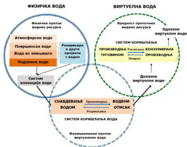
Слика 1. Однос „дводимензионалног и три елемента“ физичко-виртуелног спојеног тока воде
