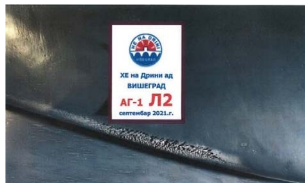
Slika 2 - Kavitaciono oštećenje na leđnoj strani, na spoljašnjoj obodnoj ivici na antikavitacionoj letvi
