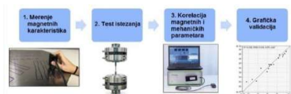
Slika 6 - Postupak kalibracije za 3MA sensor
