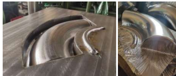
Slika 14 - Ključne površine alata i gotov deo
