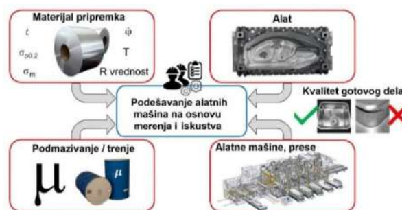
Slika 3 - Ključni činioci tehnologija plastičnog deformisanja
