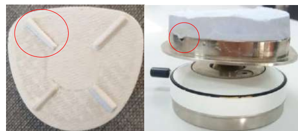
Slika 21 - Određeni nedostaci na ištampanom modelu
