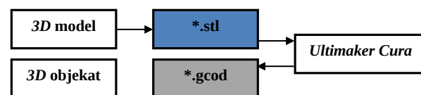
Slika 25 - Blok dijagram u realizaciji modela pomoću 3D štampača
