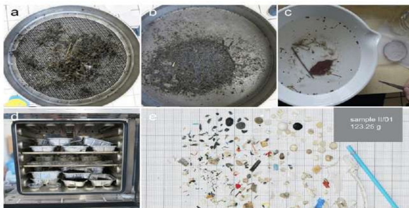
Сл. 3.11. Пробна обрада (а) и (б) каскаде за раздвајање материјала, (ц) ручно сортирање помоћу воде и NaCl, (д) узорци у сушионику, (е) примјер честица микропластике из узорка (Liedermann 2018)
