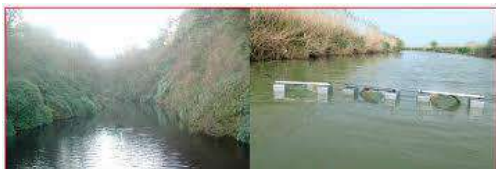
Сл. 3.10. Узорковање микропластике: а) динамичко узорковање микропластике, б) стационарно узорковање микропластике (Liedermann 2018)
