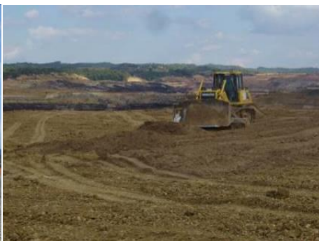
Сл. 10.16. Селективно откопавање плодног земљишта, привремено депоновање и разгртање плодног земљишта на површину депосола
