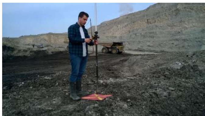
Слика 6. Одређивање координата оријентационих тачака ГПС методом
