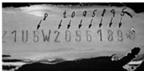
Slika 8. Izgled broja šasijske oznake nakon ispitivanja
