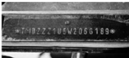
Slika 7. Izgled broja šasijske oznake prije ispitivanja
