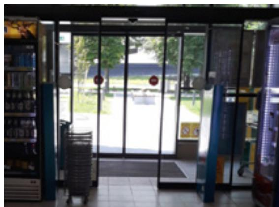
Na predmetnim vratima nakon štetnog događaja izvršen je pregled i provera opreme za rad (kliznih vrata) gde su izvršena ispitivanja električnih instalacija. Pregledom nalaza uočeno je da nisu vršeni pregledi senzora kao ni način otvaranja i zatvaranja vrata Nakon vizuelnog pregleda kliznih vrata, pristupilo se pregledu aktivacije senzora u različitim tačkama odnosno pregled momenata kada se vrata aktiviraju - otvaraju odnosno vreme zatvaranja. U odnosu
