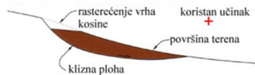
Slika 2 – Rasterećenje gornjeg, aktivnog dijela klizišta
