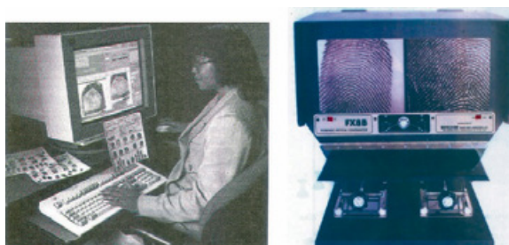
Prilog 10. Računarski sistem SAFIS MORPHO za unošenje/memorisanje nespornih otisa prsta i uređaj za komparaciju nespornih i spornih otisaka prsta 10
