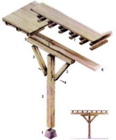
*Fig. 15. Struttura del portico ligneo medievale: 1 – isolante lapideo (gesso); 2 – colonna (castagno); 3 – puntoni; 4 – cavicchi lignei; 5 – capitello; 6 – architrave (asenare); 7 – travetti correnti; 8 – solaio.*
