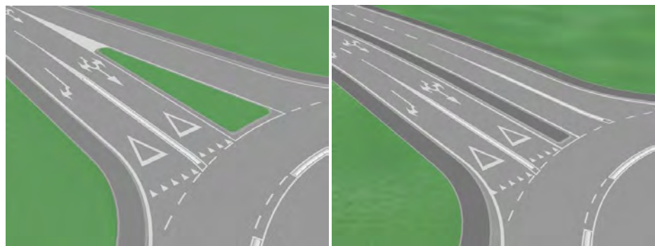
Слика 16. Раздјелно острво: троугаоног облика (лијево) и капљастиг облика (десно) [8]
