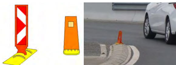
Слика 12. Плоча за наглашавање (лијево) и примејр из Словеније (десно) [2]
