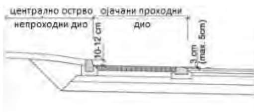
Слика 14. Дијелови централног острва турбо кружне раскрснице [2]
