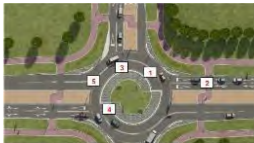
Слика 2. Главне карактеристике турбо кружне раскрснице [5]
