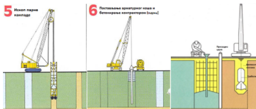
Слика 15.а .Друга фаза – Ископ по кампадама, армирање и бетонирање АБ дијафрагмедебљине 40,0 см по ободу планиране гараже
