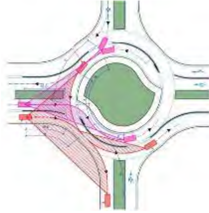
Слика 10. Троуглови прегледности (примјер за ТКР стандардне величине, дужина прегледности D_2=x_1 = 25 \text{ m} за v_n = 35 \text{ km/h} ) [2]
