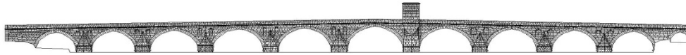
Слика 2. Мост Мехмед паше Соколовића, цртеж узводног изгледа (извод из пројектне документације А-Proje, 2013)
