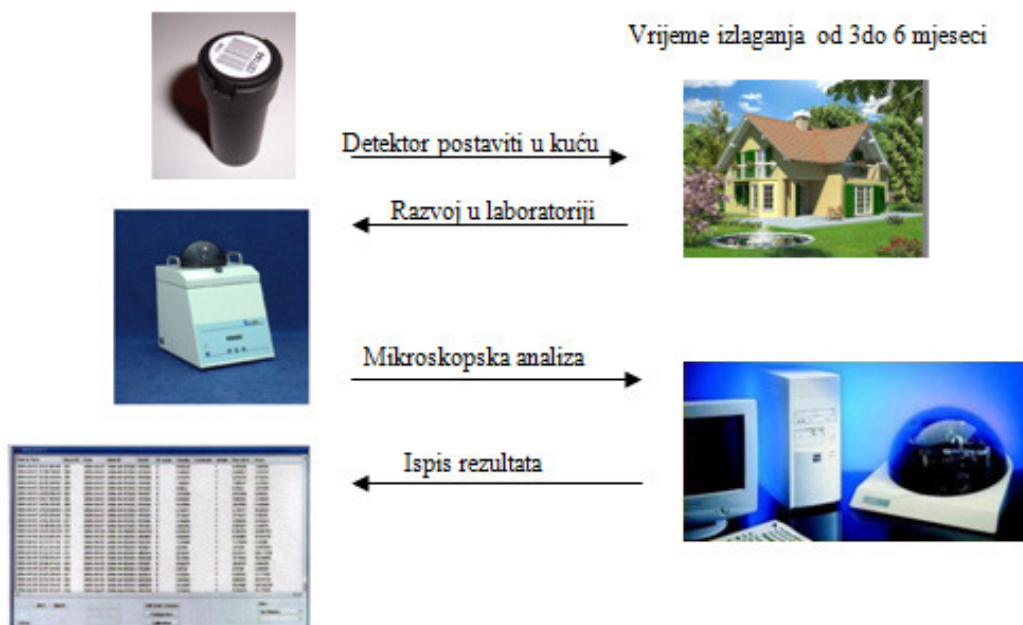
Slika 2. Redoslijed procesa testiranja radona u unutrašnjim prostorijama uz pomoć RadoSys sistema Figure 2 The order of the testing process of radon in indoor premises with RadoSys system
