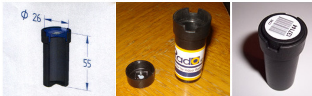
Slika 1. Difuzijska komora PADC/CR-39 detektora Figure 1. Diffusion chamber detector PADC/CR-39
